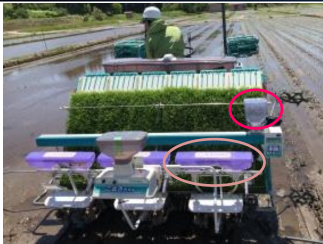
農機具メーカーと共同開発した側条施薬機（市販化）
