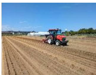
写真2 RTK自動操舵活用 ほぼ直線で播種作業
