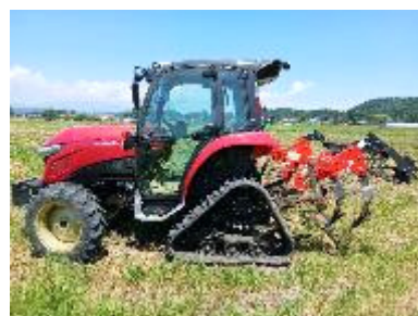
写真3 補助暗渠施工機 「ハーフソイラー」 タマネギほ場で使用
