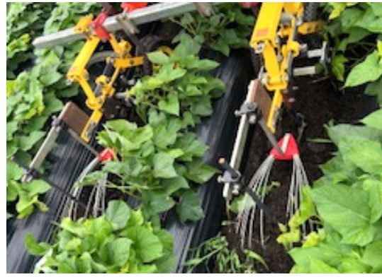
写真4 畝間除草の状況 (定植5週目)
