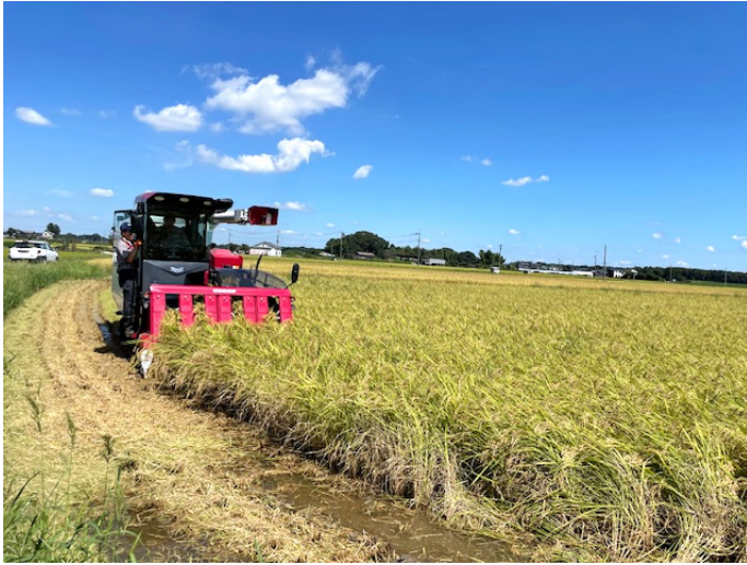
写真4 情報支援機能付コンバイン（YH7135）の作業状況
