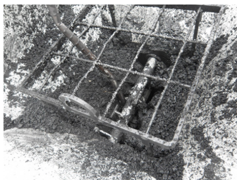
写真5 モミサブローのホッパー内で 生じたブリッジ
