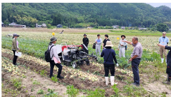
写真4 4条茎葉処理機の説明および実演
