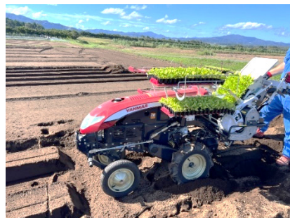
写真2 全自動野菜移植機 PW10
