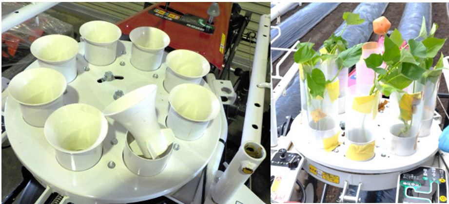
写真1 移植機の改良点：スリーブのかさ上げ（左→右にかさ上げ）
