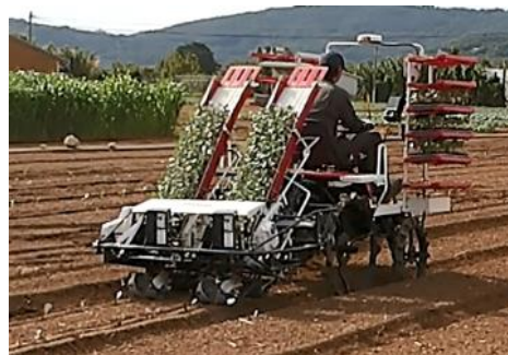
写真4 全自動移植機定植風景
