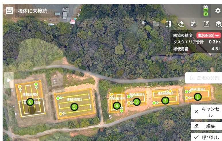
写真6 ドローン散布の飛行ルート画面例
