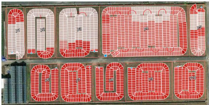
図4 可変施肥作業のログ(可変施肥区と慣行区で塗分けの水準は異なる)
