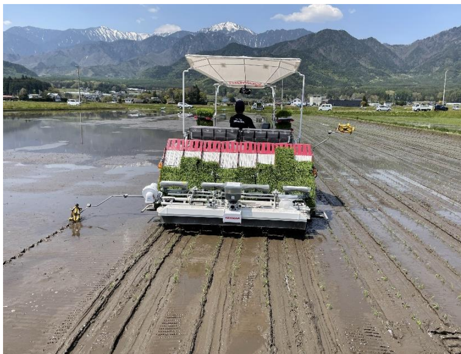
写真1 可変田植機による田植え（2020年5月4日） 直進性は抜群
