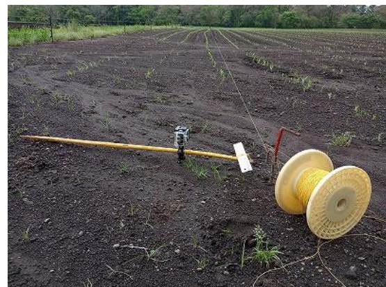
写真4. 直進性調査で用いた水糸,カメラ,定規
