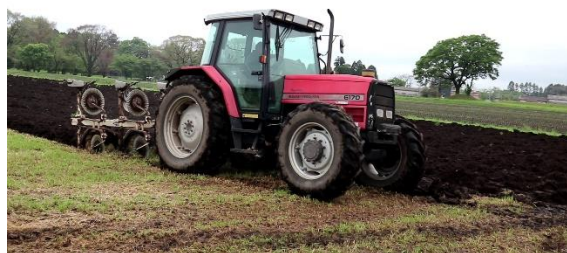
写真 12. 傾きながら作業するプラウ
