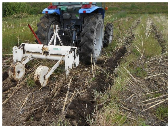
写真2 サブソイラ作業（ほ場1）
