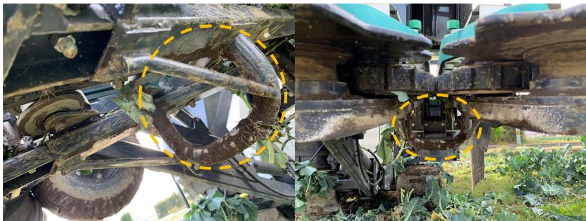
写真4 詰まりの原因となっていた収穫・搬送部の下部搬送U字補強フレーム
