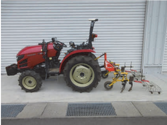
写真1 RTK仕様トラクタと畝間除草機 (ヤンマーYT225A、キューホーS4 カルチ)
