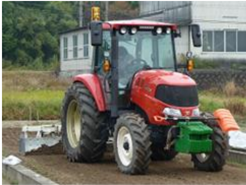
写真1 レーザーレベラーによる傾斜施工
