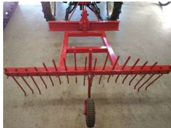
図4 カラ掻き機の取り付け状況
