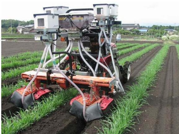
写真1 試作機培土作業
