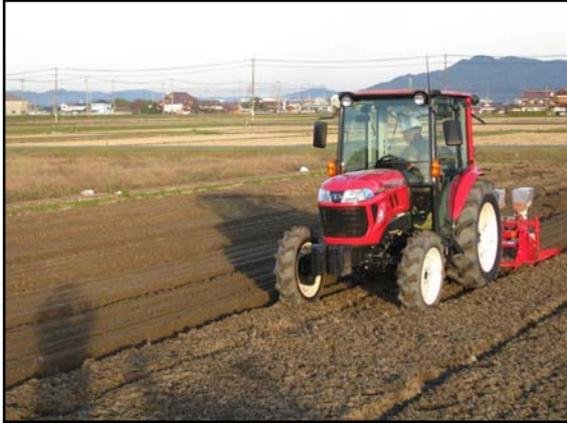
写真1 施肥播種機試験における耕起・畝立て・播種・施肥の状況（11月12日）
