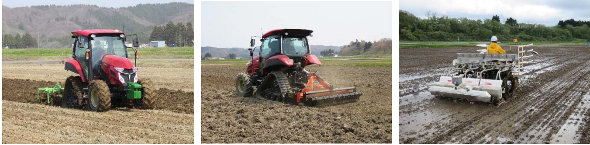
図1 無代かき湛水直播の作業の状況(左 チゼルプラウ、中 縦軸駆動ハロー、右 播種)
