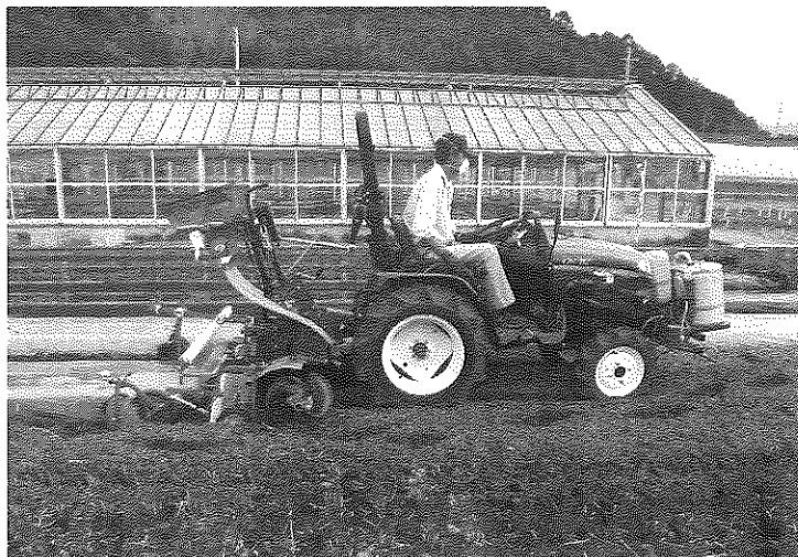
写真1 畝立・施肥・土壌消毒・マルチ同時作業
