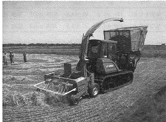
写真 2. ピックアップアタッチメントを装着したハーベスタ
