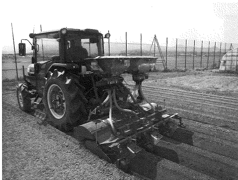
写真 畦内局所施肥成形機によるうね内部分施肥作業
