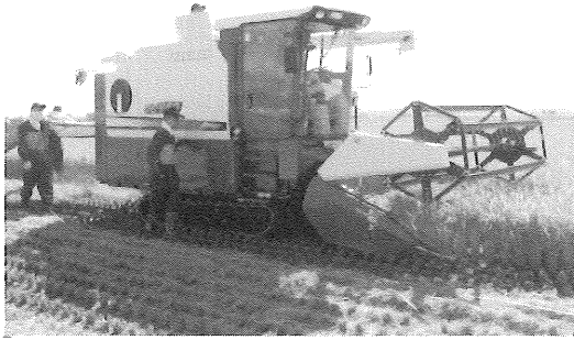
写真1 汎用コンバインによる収穫作業
