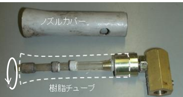
回転ノズル(左:ノズルカバーを外した状態、右:作業の様子)
