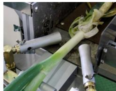
回転ノズル(左:ノズルカバーを外した状態、右:作業の様子)
