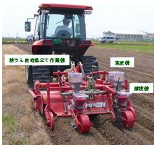
アップカッターロータリを用いた耕うん同時畝立て播種作業機
