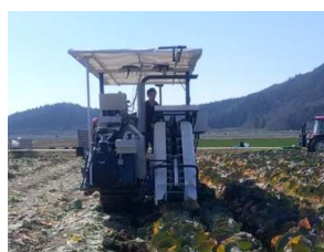
AI技術を活用した自動キャベツ収穫機 省力化、収穫ロス削減
