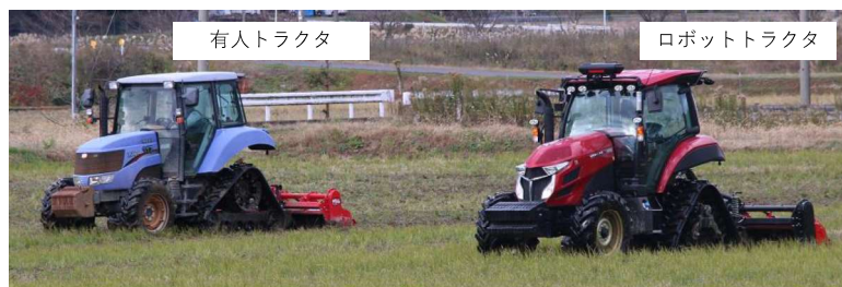
ロボットトラクタと有人トラクタによる協調耕うん
