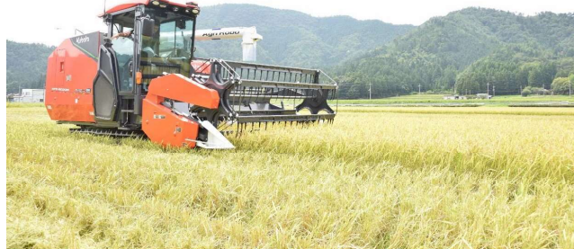
食味収量測定機能付自動運転普通コンバイン（クボタ社製）
