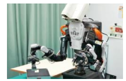
弁当の盛付 などの繰り返し作業を 自動で行う ロボット
