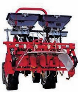
写真2 畝内局所同時施肥整形作業機セット (平高うね整形ロータリー BS140CH + 施肥口セット RC14SG + 施肥機)
