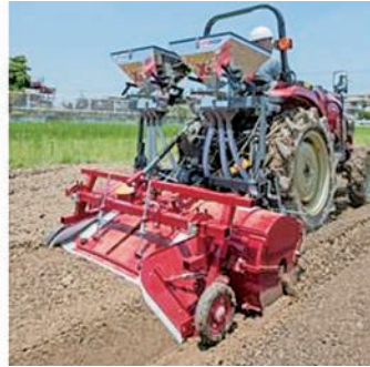
写真2 畝内局所同時施肥整形作業機セット (平高うね整形ロータリー BS140CH + 施肥口セット RC14SG + 施肥機)
