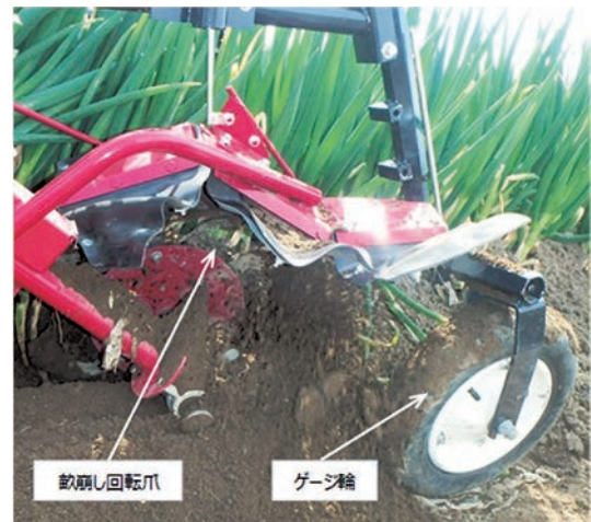
図5：畝崩し用回転爪とゲージ輪
