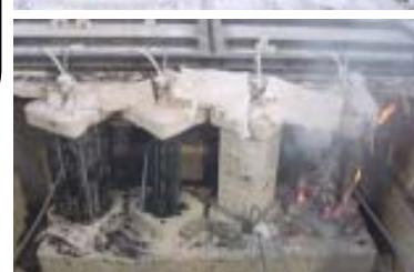
実大試験体による燃焼試験の実施と耐火性能認定取得の可能な複合構造材の開発
