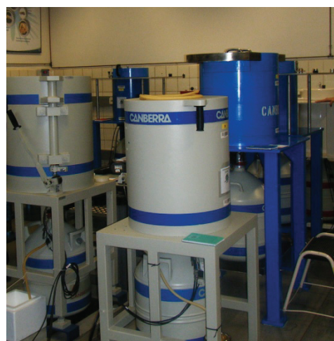
SCK・CEN で稼働中のゲルマニウム半導体検出器
